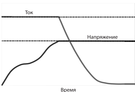
Рис.1 Зависимость тока и напряжения заряда от времени в режиме IU без ступени ускоренного заряда.
