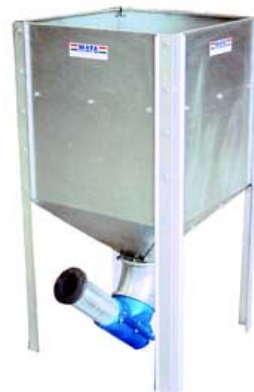
Бункер MAFA MINI с недельным запасом топлива (300 литров)
