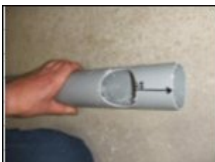
7. Когда отверстие будет готово, обточите его напильником, чтобы края были ровными.
