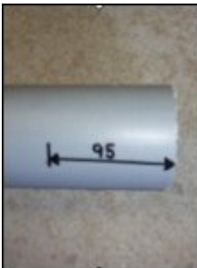
1. Отмерьте 95 мм от края трубы шнека.
