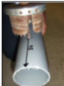
2. Возьмите пилу для выпиливания отверстий диаметром 90 мм.
