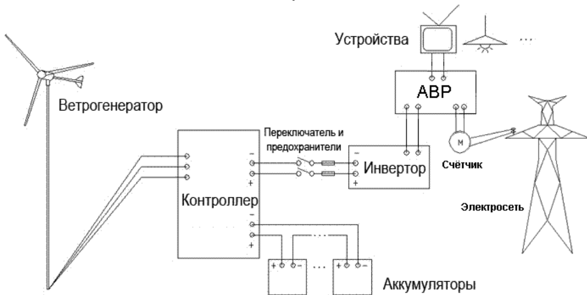
Обеспечение объекта (с аккумуляторами) и коммутация с сетью Рисунок 2
